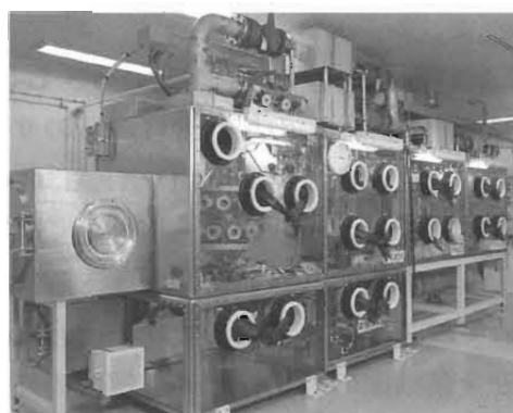
写真2 エアロゾル吸入実験装置 (出典:放射線医学総合研究所パンフレット)
