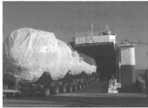
図1 蒸気発生器の海上輸送
